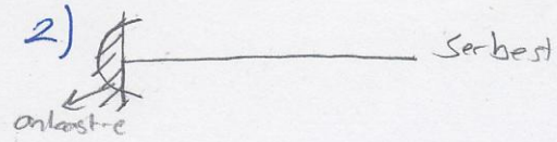
Konsol kiris (projektor) bir ucu ankastre (clamped) diğer ucu serbest
